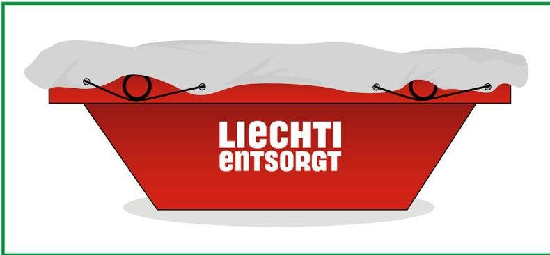
Für einen gefahrlosen Transport und damit die Mulde unter den Aufladearm passt, dürfen Mulden nicht überfüllt sein. Der Chauffeur muss die Mulde noch mit einem Netz abdecken können.
